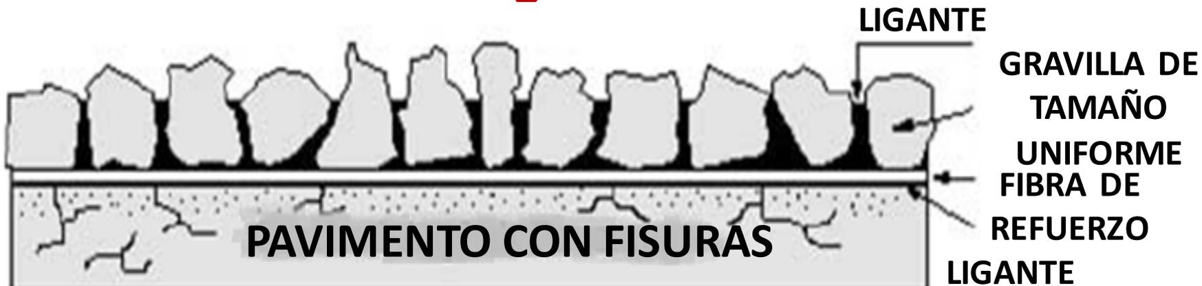
**Riego de sello sincronizado con fibra, es una modalidad del riego sincronizado que se está utilizando en nuestro país, con la finalidad de mitigar el agrietamiento reflexivo de baja severidad incrementando la vida útil del tratamiento para lo cual se utiliza una fibra sintética.**
