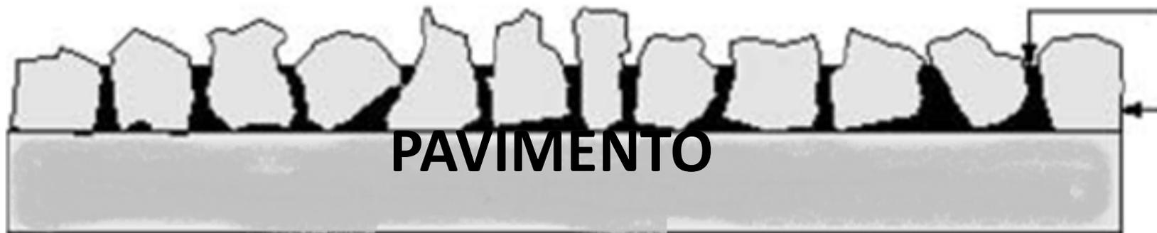
Los riegos de sello simple se emplearan exclusivamente en tratamientos de conservación, para restituir la resistencia al deslizamiento de superficies de características homogéneas con buena regularidad superficial.
