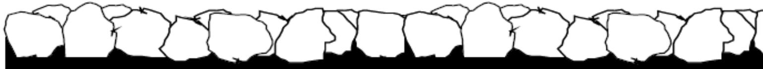
Se define como Riego de Sello o Riego de Gravilla, al tratamiento superficial consistente en la aplicación de una o varias capas de un ligante asfáltico sobre una superficie , complementada por una o varias extensiones de un agregado de granulometría definida
